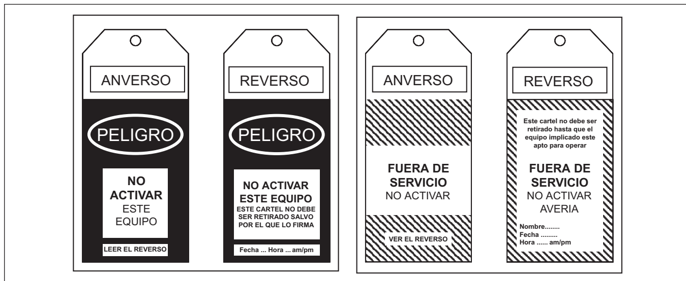
Figura 6 - Ejemplos de carteles que pueden colocarse sobre los dispositivos de maniobra para que no sean accionados.
